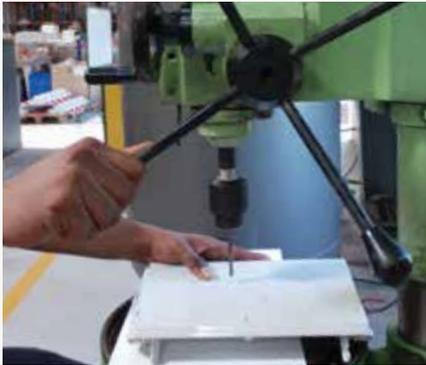
+ Leichte Bearbeitbarkeit – einfache Befestigung von Tastern, CEE-Steckdosen usw.
