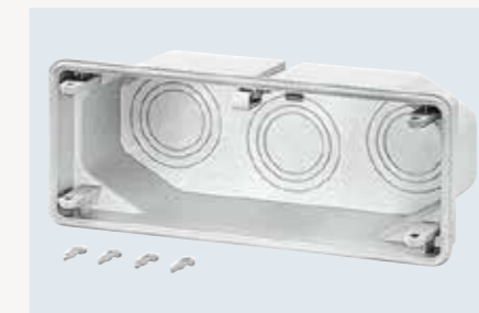
法兰盘 + 集成有不同敲落孔或弹性密封膜的法兰盘可通过楔形连接安装在任一箱壁上，也可以将来再安装。 + 加深型的法兰盘给电缆连接提供足够的延展空间。
