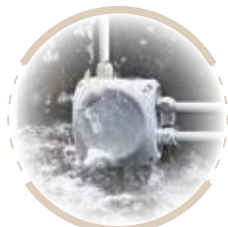
Řada WP: IP 66 / IP 68 / IP 69 ponoření do 20 m po dobu 168 h vodotěsné, k zalití zalévací hmotou, se svorkami, metrické předlisý
